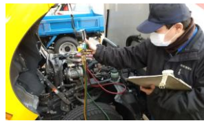
保冷車の点検
